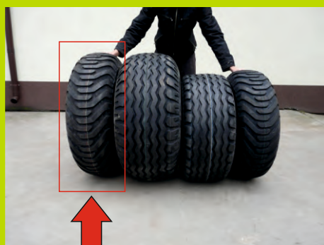
Dla wersji jednoosiowych Koło 11,5 - 15,3 szer. 300 mm
