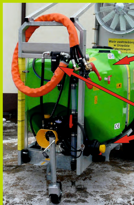
Rama opryskiwacza ocynkowana ogniowo
