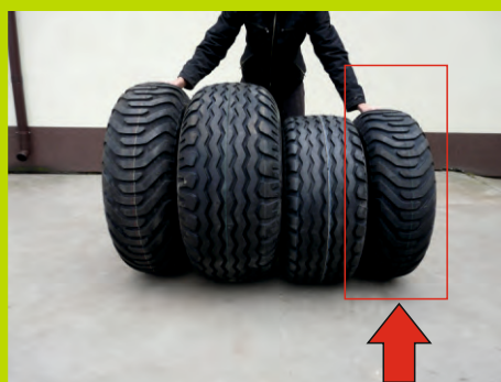
Dla wersji dwuosiowych Koło 10 - 15,3 szer. 240 mm
